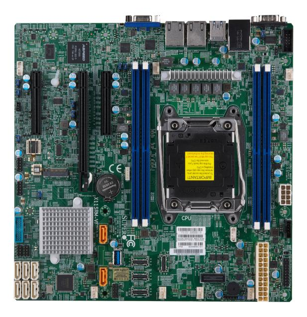
Figure 1-2. X11SRM-VF Motherboard Image
